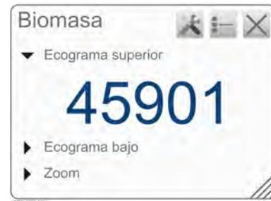
Sólo se muestra la biomasa calculada para el transductor y frecuencia actuales.
