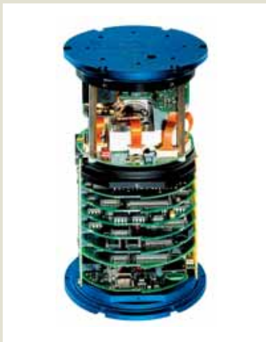
Fig. 1 – Eksempel på bruksområde for bevegelsessensor (MRU – Motion Reference Unit)
