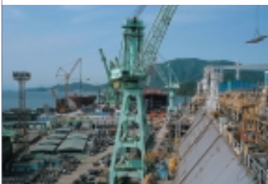
LNG-skip under bygging på Samsung verft i Sør-Korea
