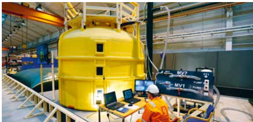
Bildet viser en SSU skalamodel. (Modellen er i størrelsen 1:10)
